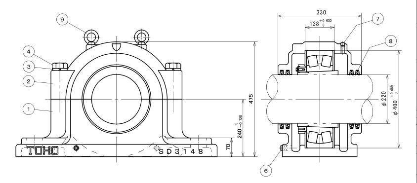
塗装色:マンセル5B4/1.5 アイボルト SS400 2 M16 4 ZF48 オイルシール NBR 給油栓 SS400 1 PT1/4 排油栓 SS400 PT3/8 テーパーピン SS400 六角ボルト SS400 4 M30 バネ座金 SWRH62B 4 M30 軸受箱上 FC200 軸受箱下 FC200 材質 摘 要 個数 部品名称
