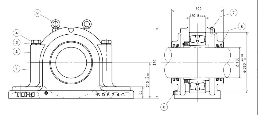
塗装色:マンセル5B4/1.5 2 M12 アイボルト SS400 4 ZF34 オイルシール NBR PT1/4 給油栓 SS400 2 PT3/8 排油栓 SS400 テーパーピン SS400 六角ボルト SS400 4 M30 バネ座金 SWRH62B 4 M30 軸受箱上 FC200 軸受箱下 FC200 部品名称 材 質 個数 摘 要
