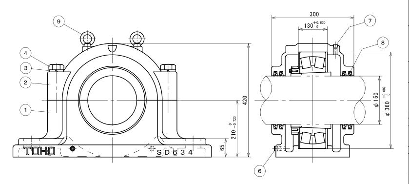
塗装色:マンセル5B4/1.5 2 M12 アイボルト SS400 4 ZF34 オイルシール NBR 1 PT1/4 給油栓 SS400 排油栓 SS400 2 PT3/8 テーパーピン SS400 六角ボルト SS400 4 M30 バネ座金 SWRH62B 4 M30 軸受箱上 FC200 軸受箱下 FC200 部品名称 材 質 個数 摘 要
